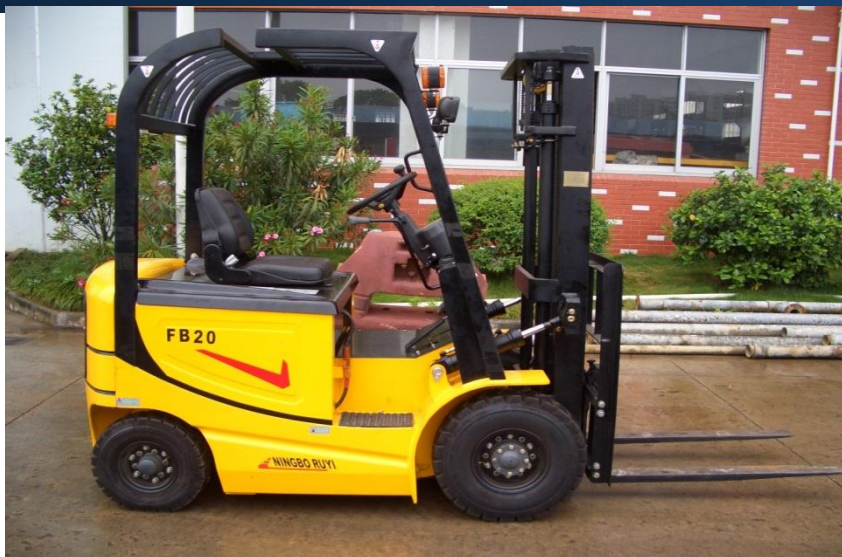
图7 国产轻量化设计的2吨电动叉车
