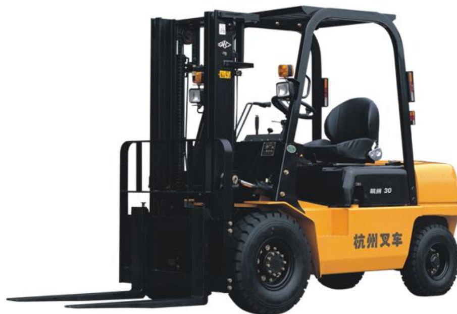
图1B 国产内燃平衡重式3吨叉车
